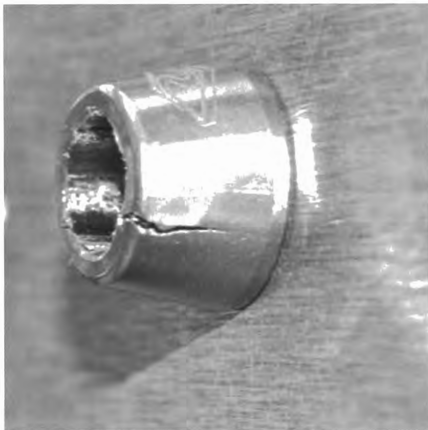
Fig. 16 - Rottura della testa di una vite M8 in titanio in fase di serraggio imputabile all'attrito elevato (serraggio senza lubrificante, T \approx 65 \text{ Nm} - F_t \approx 28 \text{ kN} ).
