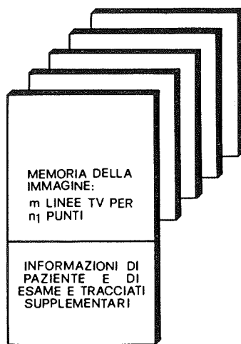
Fig. 5.3.1.2. Configurazione schematica delle matrici di memoria digitale.
