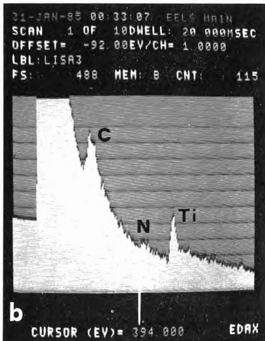
Fig. 16. a. Micrografia TEM di una sezione trasversale di un dispositivo a semiconduttore al Si. Sono visibili gli strati di Si, TiN, Al e di colla C. La barra indica 100 nm. b. Spettro EELS ad elettroni, acquisito in una regione del TiN. Sono visibili i bordi K ed L_{23} dell'N e del Ti, rispettivamente a 400 e 455 eV. Il bordo K del C a 284 eV è prodotto da contaminazione carboniosa. c. Spettro EDS a raggi X preso all'interfaccia TiN/Si. I picchi AlK\alpha , AlK\beta (1490 e 1560 eV) e SiK\alpha , SiK\beta (1740 e 1840 eV) sono sovrapposti, mentre risultano separate le righe TiK\alpha (4510 eV) e TiK\beta (4930 eV). Si noti che quand'anche lo spettrometro EDS fosse stato messo in condizioni tali da poter rivelare i raggi X molli dell' NK\alpha (390 eV), la sua scarsa risoluzione ed efficienza non avrebbero praticamente consentito di distinguere la riga NK\alpha da quella TiL\alpha (450 eV).
